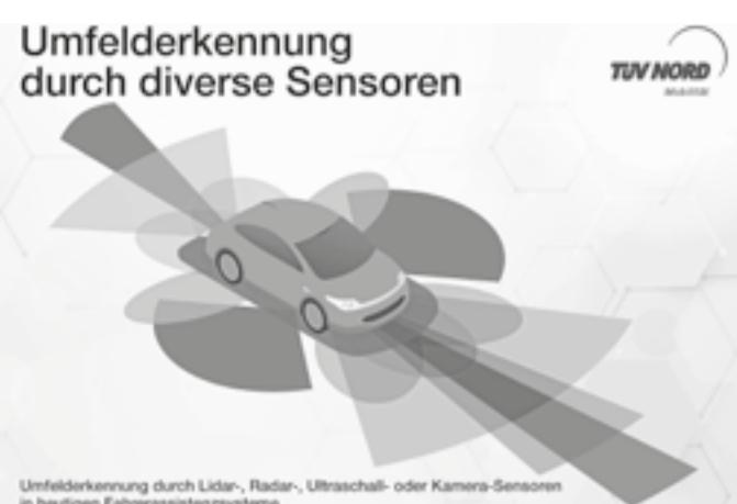
Umfelderkennung durch LIDAR-, Radar-, Ultraschall- oder Kamera-Sensoren in heutigen Fahrerassistenzsystemen.
